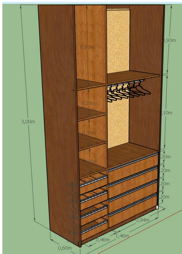
Figura 8 – Guarda-roupa modular elaborado com madeira de pallets.
