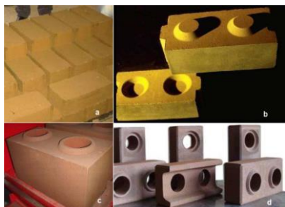
Figura 1 – Exemplo de Blocos de Solo-Cimento Fonte: Arquivo pessoal
