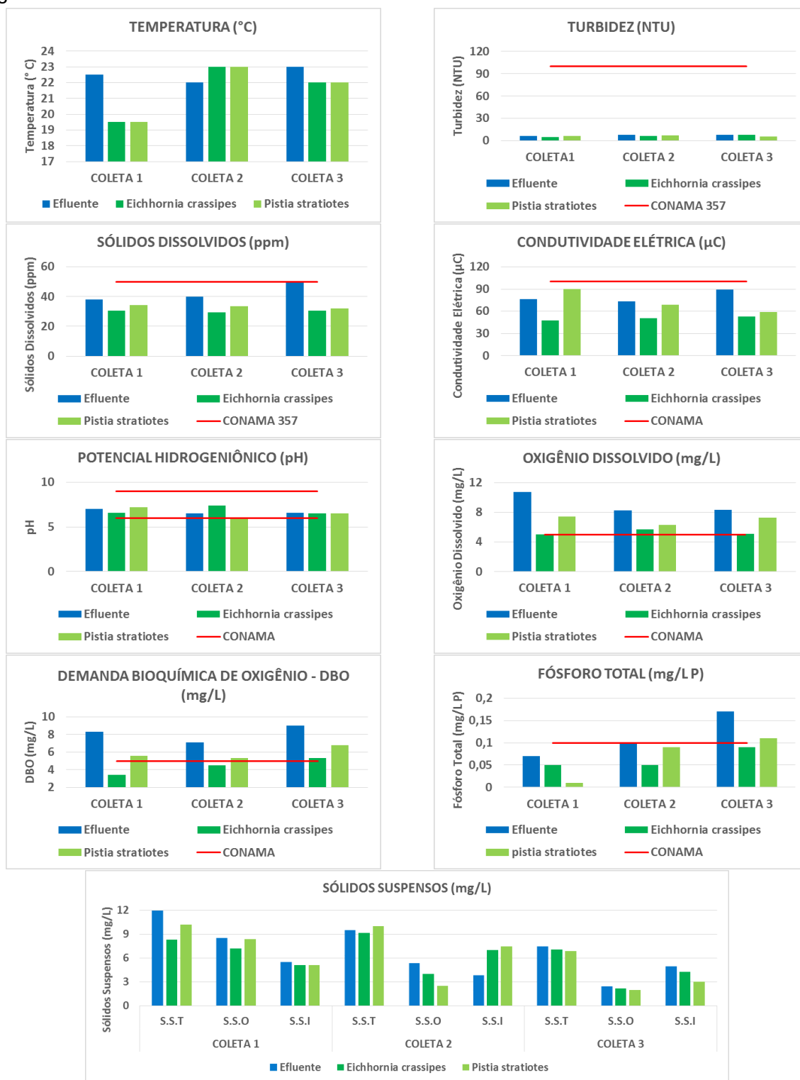
Figura 3: Parâmetros limnológicos dos efluentes antes e depois de tratados, nas três coletas realizadas, sendo a barra azul o efluente sem tratamento, a barra verde escuro o efluente tratado pela Eichhornia crassipes e a barra verde claro o efluente tratado pela espécie Pistia stratiotes .
