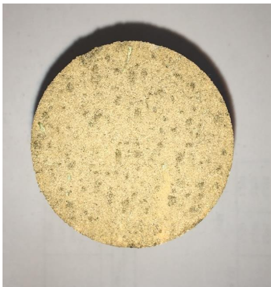
Figura 3 - Corpo-de-prova com teor 2,5% após ser retirado da estufa a 90°C.
