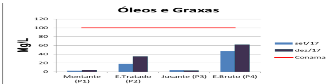
Figura 15: Variação dos valores de óleos e graxas da água e efluente nos pontos de amostragem ao longo do córrego do Retiro e na ETE Camuá, Araxá/MG, 2017.
