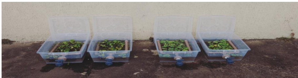
Figura 2: Protótipo usado no processo de fitorremediação do efluente do Córrego Santa Rita. Os dois primeiros (à esquerda) foram introduzidos a Eichhornia crassipes e nos dois últimos a macrófita Pistia stratiotes .
