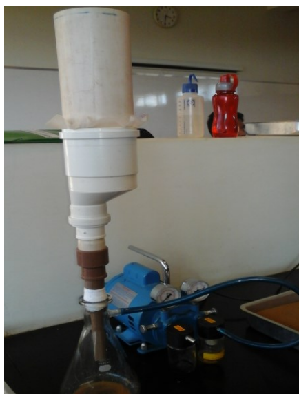
Figura 3 - Suporte para o meio filtrante acoplado ao kitassato. Fonte: Autoria própria.
