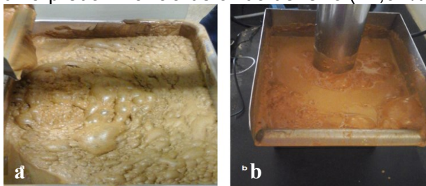
Figura 5- a) Concentrado; b) rejeito da flotação. Fonte: Autoria própria.
